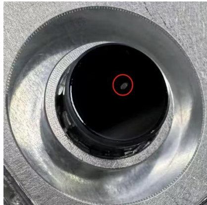
图 4 被反射光烧伤的内部反射镜片
