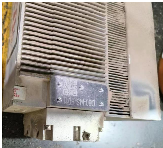
图 1 散热片内布满灰尘的 D60 激光器
